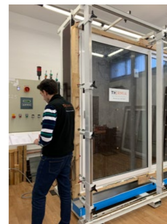
Resultados obtenidos de los informes según ensayos en laboratorio interno, y en base al Anexo E de la norma EN 14351-1:2006+A2:2016
