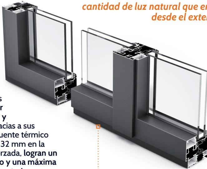
Además, estas ventanas permiten también, crear atmósferas acogedoras y confortables ya que, gracias a sus perfiles con rotura de puente térmico de 24 mm en el marco, 32 mm en la hoja y junta central reforzada, logran un alto aislamiento térmico y una máxima atenuación acústica del exterior.
